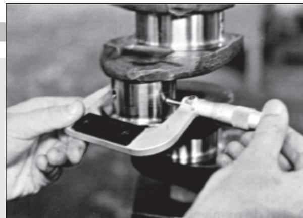
O processo de acondicionamento de um motor é composto por um conjunto de operações que envolve a desmontagem completa, inspeção visual e dimensional, usinagens, medições de controle, recuperação de ângulos de assentamentos e a montagem dos componentes com troca de peças. Tudo deve ser executado conforme as especificações de folgas, regulagens e torques, exatamente como os fabricantes recomendam.
