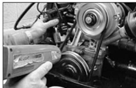
No motor com injeção eletrônica, a posição do distribuidor é a referência básica para a injeção seqüencial. É esta regulagem que define o exato momento em que as válvulas injetoras devem começar a injetar combustível.
