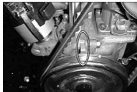
5. Remova as duas tampas de válvulas. Verifique a folga somente no primeiro cilindro, com o auxílio de um calibre de folga, posicionando-o entre o parafuso do balancim e a haste da válvula. A folga das válvulas, tanto de admissão como de escape, deve ser regulada com 0,10 mm.
